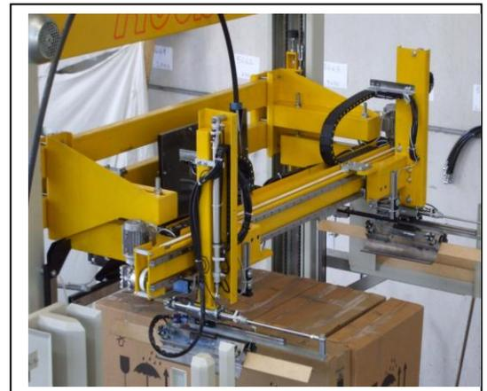
I manipolatori appoggiano l'angolare sui lati del pallet con uno speciale dispositivo l'angolare viene allineato perfettamente all'angolo del pallet e lì trattenuto fino alla chiusura del primo lancio di reggia. A legatura finita la testa di reggiatura si muove su due assi di libertà in modo da lanciare più di una legatura su tutta la lunghezza del pallet.
