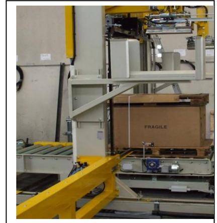
del pallet e si ricongiunge con l'arco di reggiatura che viene così chiuso e la testa di reggiatura scende fino all'altezza del pallet innescando il tensionamento e la saldatura che può essere a seconda delle esigenze a caldo o a vibrazione, l'operazione viene ripetuta a seconda delle esigenze lo stesso vale per il lato opposto, ruotando l'UDC tramite la base rotante.
